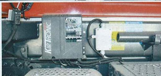
Il Kip Tronic può controllare direttamente sino a 16 uscite, quindi 16 funzioni specifiche, di cui 8 con assorbimento massimo di 1 ampere e 8 con assorbimento massimo di 0,5 ampere. Tramite stadi di potenza aggiuntivi può controllare direttamente attuatori e motori elettrici.
